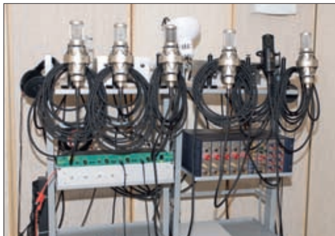
In der Hörkabine werden alle Mikrofone mehrere Tage auf Funktionalität und Klang überprüft. An den offenen Netzteilen erfolgt die finale Feineinstellung
