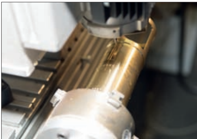
In der hauseigenen CNC-Fräse erhält der Hülsenrohling Logo, Schriftzug und Seriennummer
