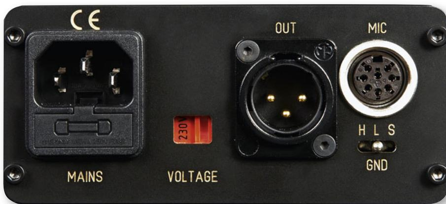
Die achtpolige Buchse für das Vovox-Mikrofonkabel ist mit einem feinen Gewinde versehen, um eine sichere Verbindung zu garantieren.
