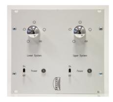
Das Netzteil Ihres Mikrofons ist in Kassettentechnik aufgebaut und kann somit in einem 19"-Rack (3 HE) mit weiteren Netzteilen oder Vorverstärkern installiert werden. Das Netzteil ist gleichzeitig die "Fernbedienung" des Mikrofons. Es besteht intern aus zwei vollkommen eigenständigen Netzteilen für jedes der beiden Mikrofonsysteme. So wird zum einen die höchstmögliche Kanaltrennung erreicht und zum anderen kann das VM1S auch als Einzelmikrofon betrieben werden.
