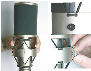
Um den mitgelieferten Windschutz an der Aufhängung anzubringen, schrauben Sie zunächst die beiden Rändelschrauben aus den Gewinden am Windschutz. Setzen Sie ihn nun so auf den Außenring der Aufhängung, dass die Haltestege des Windschutzes im inneren Ring der Spinne gleichauf mit den dortigen, mit schwarzen Kunststoffringen umrandeten, Gewindelöchern liegen. Arretieren Sie jetzt Spinne und Windschutz mit den Rändelschrauben, so dass beide fest und ohne Spiel verbunden sind.
