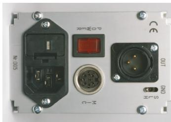
Auf der Rückseite des Netzteils finden Sie zum einen drei Anschlussmöglichkeiten: die Buchse für das Kaltgerätekabel zur Stromversorgung, die Tuchelbuchse des Mikrofonkabels und den XLR-Ausgang des Audiosignals zum Vorverstärker oder Mischpult. Die XLR-Kupplung ist normgerecht beschaltet und führt das phasengleiche Signal auf Pin 2 des XLR-Steckers (2 - „heiß“). Des Weiteren finden Sie dort den Erdfreischalter (bzw. Groundlift), den Netzschalter und den Sicherungshalter.
