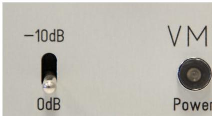
Mit diesem Schalter können Sie die Empfindlichkeit der Mikrofonkapsel um 10 dB herabsetzen, um eine höhere Aussteuerbarkeit zu erreichen. Dieses bietet sich an, wenn extrem laute Quellen den Mikrofonvorverstärker überlasten. Das Mikrofon selbst kann einen Grenzschalldruckpegel von 140 dB verarbeiten, ohne das sonst bei Röhrenmikrofonen übliche Kompressionsverhalten zu zeigen. Das Dämpfungsglied werden Sie also nur in wenigen Ausnahmefällen wirklich brauchen.
