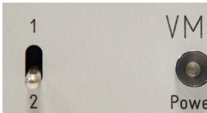
Beim VMA befindet sich an der Stelle des 10 dB-Dämpfungsschalters der Wahlschalter für die Klangcharakteristik. Die untere Position entspricht dem Klang des VM1 (hohe und gleichmäßige Durchzeichnung über den gesamten Frequenzbereich), die obere dem VMX (feine und vergleichbar weichere Abbildung der Höhen, sowie leichte Betonung der oberen Mitten und Tiefen).
