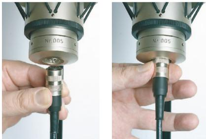
Prüfen Sie bitte zunächst alle Kabel auf Schäden und vergewissern Sie sich, dass das Netzteil ausgeschaltet ist. Verbinden Sie nun zunächst Mikrofon mit Netzteil, indem Sie die achtpoligen Tuchelbuchsen in die Tuchelstecker stecken (Führungsnut beachten) und die Überwurfhülsen handfest verschrauben. Dies verhindert eventuelle Brummstörungen.
