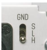
Der Erdfreischalter, oder auch Groundlift, hat die Aufgabe, den Pin 1 des XLR-Ausgangs (Masse) erdfrei zu schalten. Die Schutzterde wird dabei selbstverständlich nicht unterbrochen. Dieser Schalter kann bei Brummproblemen, wie sie bei Differentialunterschieden entstehen, Abhilfe schaffen.
